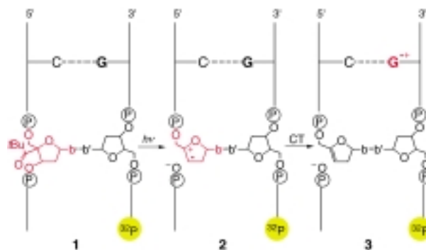
Schema 1. Erzeugung eines Guaninradikalkations G^{\bullet+} im ^{32}\text{P} -markierten Strang 3 durch Photolyse des acylsubstituierten Stranges 1 .
